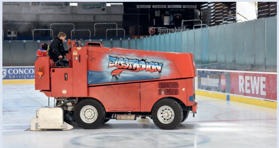
Eismeister Finlay Harrold bereitet das Eis mit der Eismaschine vom Typ Zamboni auf. Fotos: LSB
